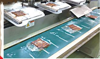
艶やかに仕上がった蒲焼を冷却器で冷やし、金属探知機にかけ計量後真空パックにします。熱湯でボイル殺菌を行い、凍結して冷凍保存の後出荷します。
